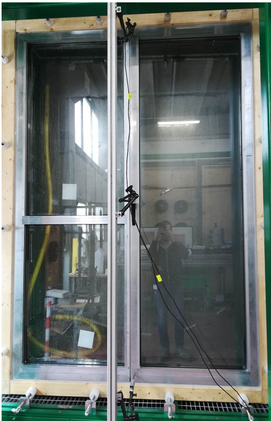
Foto 3. Campione sottoposto a prova durante i test di resistenza al carico del vento
