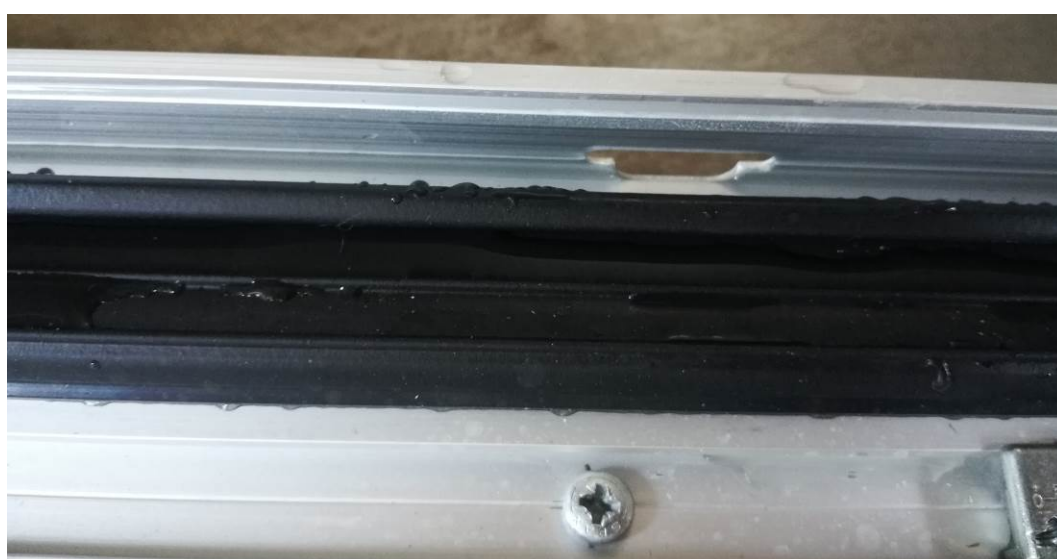
Foto 12, Foto 13 e Foto 14. Dettaglio degli accessori e delle asole di scarico del campione sottoposto a prova
