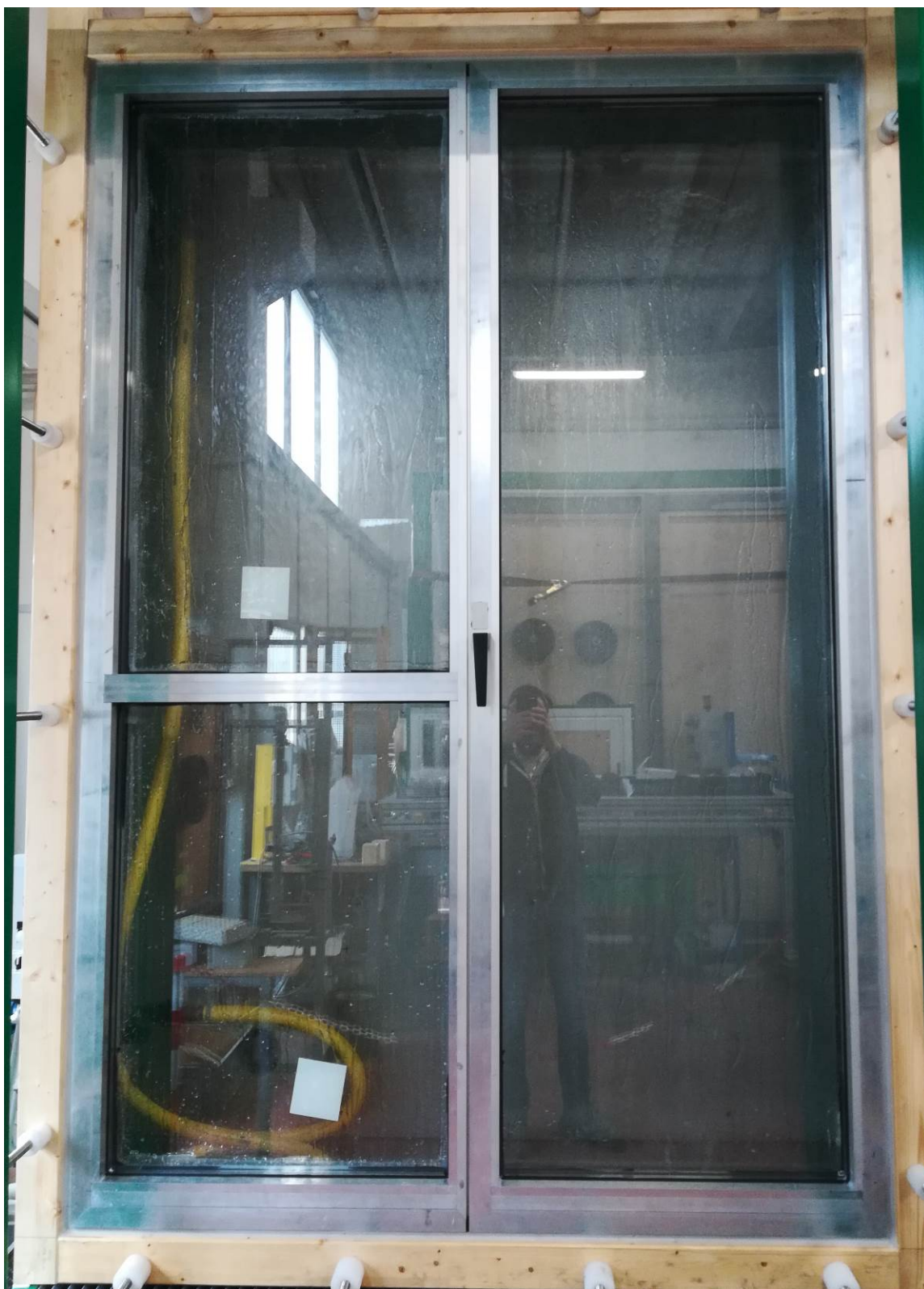
Foto 2. Campione sottoposto a prova durante i test di tenuta all'acqua
